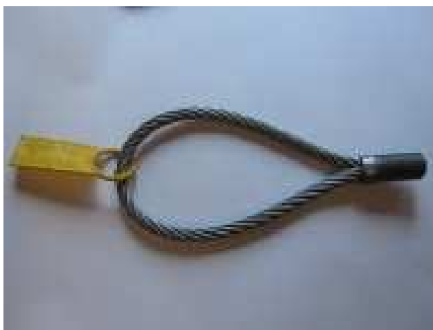
Kuva 2. ASPO-portaiden (tyypit A, B ja C) nostoihin käytettävä vaijerinostolenkki (3 kpl/porras)
